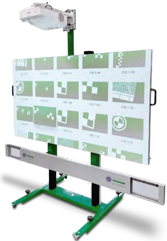
Kernbestandteile des CSC-Tool Digital sind ein elektromechanisch verstellbarer Screen mit der oben montierter Apple-TV-Box und ein Kurzdistanz-Beamer.
