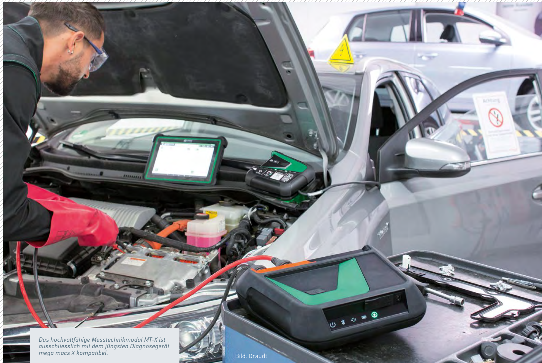
Erster Schritt: Die Prüfung der Spannungsfreiheit des HV-Systems
