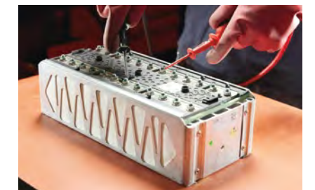
Das Separieren und Ersetzen von Batteriemodulen, ist Hochvoltexperten der Stufe 3S vorbehalten und steht heute noch am Anfang.
