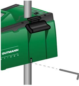
Pour corriger le réglage du guide de colonne, utiliser une clé à six pans SW 6.
