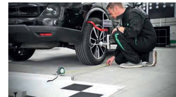
Das CSC-Tool-Zubehör wird laufend ergänzt. Im Bild die Kalibriertafel für Nissan-Modelle mit Rückfahrkamera und Totwinkelassistent.
