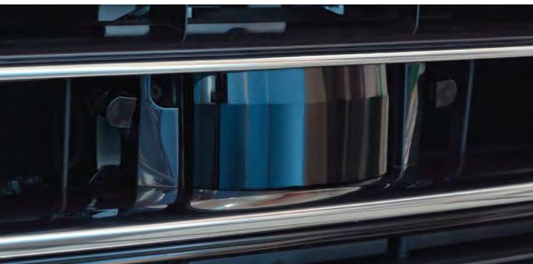
Das optische System arbeitet zwar auch bei Dunkelheit, braucht aber ‚Durchblick‘. Der Laserscanner wird deshalb beheizt und ist mit einer Reinigungsanlage ausgestattet.
