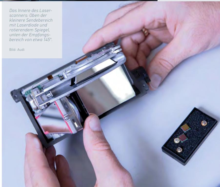
Das Innere des Laserscanners: Oben der kleinere Sendebereich mit Laserdiode und rotierendem Spiegel, unten der Empfangsbereich von etwa 145°.
