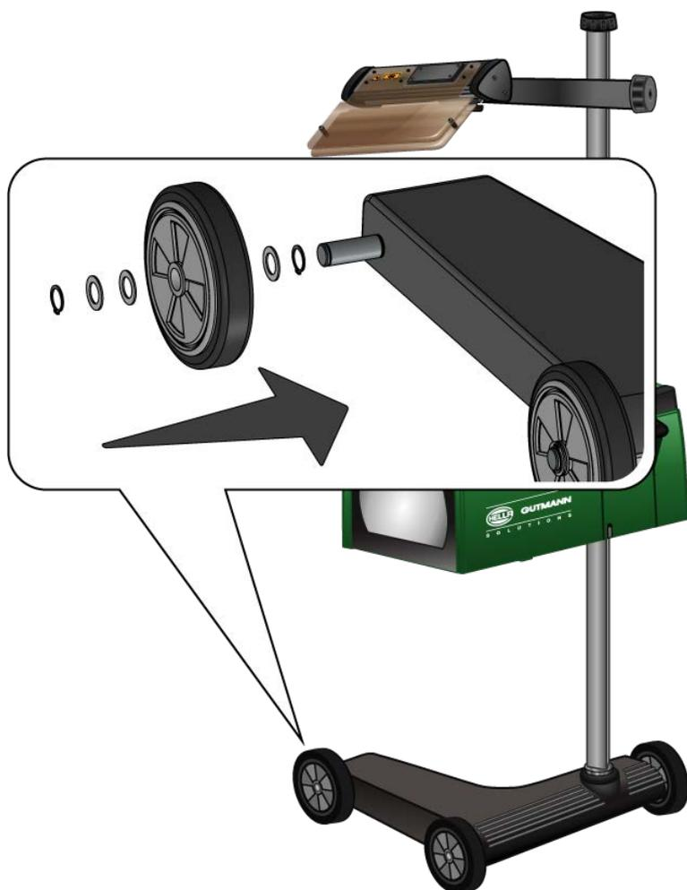
1. Positionner l'une des rondelles sur l'axe et la glisser jusqu'au contact avec le clip de fixation.
