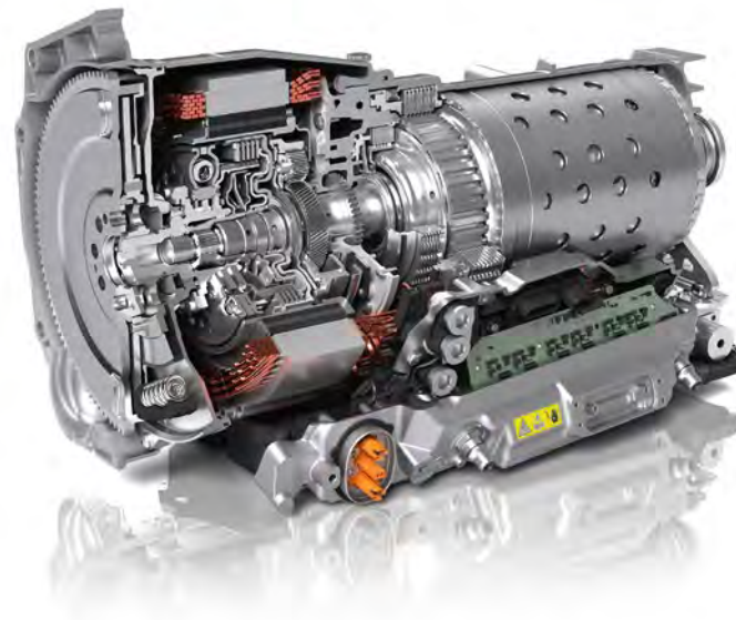
Die 4. Generation des 8-Gang-Automatgetriebes für Längseinbau wurde von ZF konsequent als Baukasten für Mild-, Voll- und Plug-in-Hybride konzipiert und integriert die E-Maschine sowie die Leistungselektronik.
